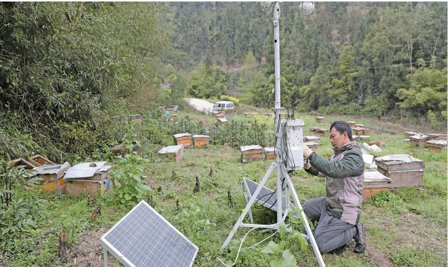
工人在检查智慧养蜂云平台的物联网系统。
