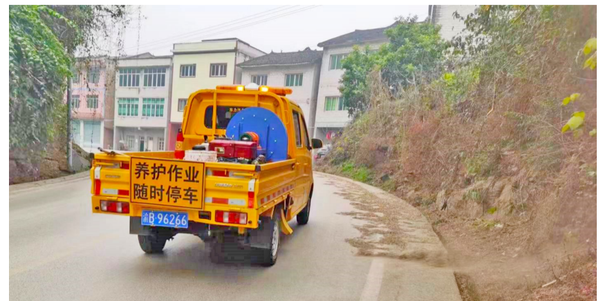
配备了简易公路养护清扫作业装置的养护车辆正在作业。
