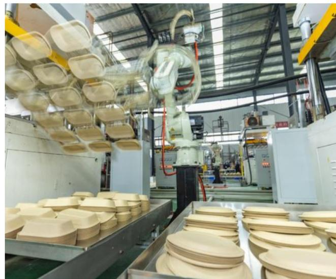
生产竹制餐具的自动化生产线 (图片由瑞竹公司提供)
